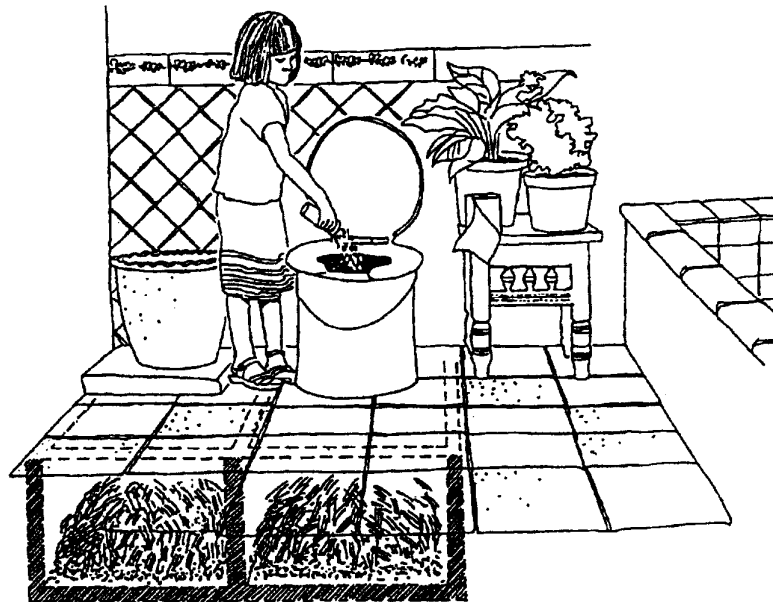
Figura 3: Letrina seca basada en el sistema de deshidratación (Añorve, 2006).
